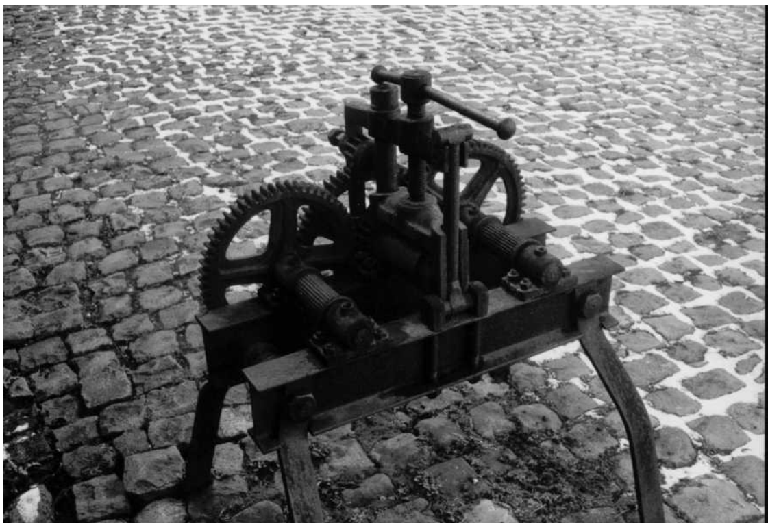
Ja Rolmachine met 3 walsen voor het krommen van de hoepels hoepels (Met dank aan Marcel Messiaen, Openluchtmuseum Izenberge)
