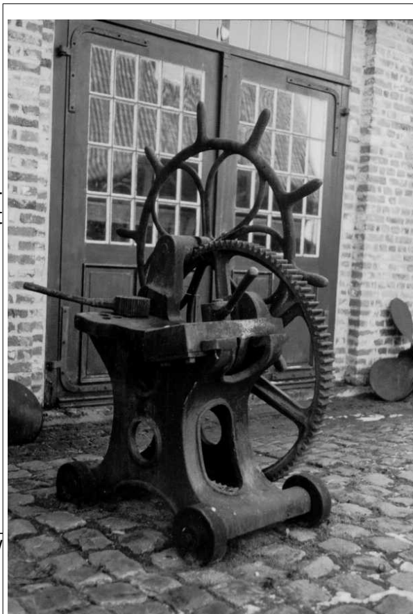
Stuikmachine voor het inkorten van te groot geworden hoepels (Foto met dank aan Marcel Messiaen, Openluchtmuseum Izenberge)
