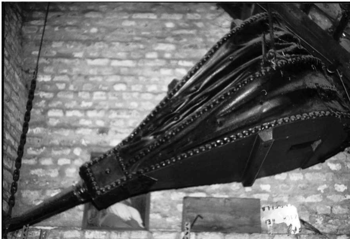
Voor het invoeren van de elektrische ventilatoren werden de vuren met dergelijke blaasbalgen aangewakkerd. (Foto met dank aan Marcel Messiaen, Openluchtmuseum Izenberge)
